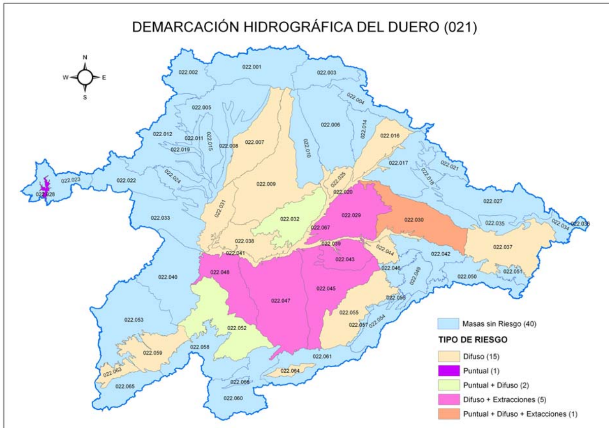
Figura 2.- Tipología de las MASb en riesgo en la Demarcación Hidrográfica del Duero
